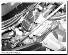
RH SIDE — REAR CYLINDER 1. Spark plug
