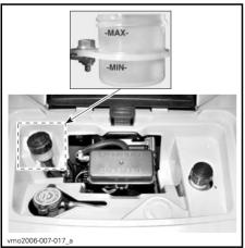
TYPICAL - BRAKE PEDAL FLUID RESERVOIR
