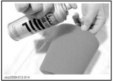
TYPICAL - OIL THE FOAM FILTER ELEMENT
