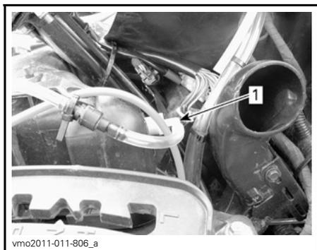
1. Entrada do filtro de ar do compressor da ACS na tampa da caixa do filtro de ar
