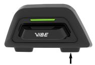
Mantenga presionado el botón de configuración durante 3 segundos, para acceder al menú de configuración. Luego, puede ir a la aplicación del vehículo tocando dos veces el botón "arriba". Toque el botón central para seleccionar "sincronización del vehículo". A continuación y desde su teléfono, diríjase a la opción de configuración del sistema Bluetooth y seleccione su dispositivo Vibe en la lista disponible.
