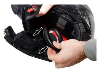
**A.8.** Vuelva a acoplar el cable del altavoz con el conector hembra NEGRO de la unidad principal. Repita en el otro lado.
