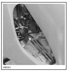
CHOKE LEVER IN THE FULL CHOKE POSITION
