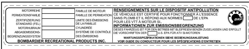
TYPISCH - ANWENDBAR, WENN EINEM NACH EPA-STANDARDS DER USA ZERTIFIZIERTEN MODELL GLEICHWERTIG - ORT: UNTER DEM HINTEREN KOTFLÜGEL
