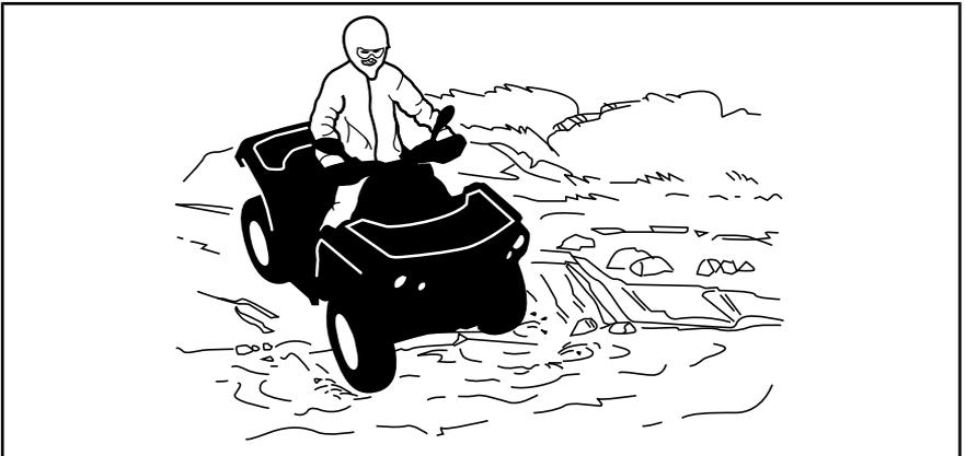
Nasse Bremsen beeinträchtigen die Bremsleistung Ihres Fahrzeugs. Sorgen Sie durch mehrfaches Betätigen dafür, dass Ihre Bremsen wieder trocken werden, nachdem das Fahrzeug das Wasser, Schlamm oder Schnee verlassen hat.
