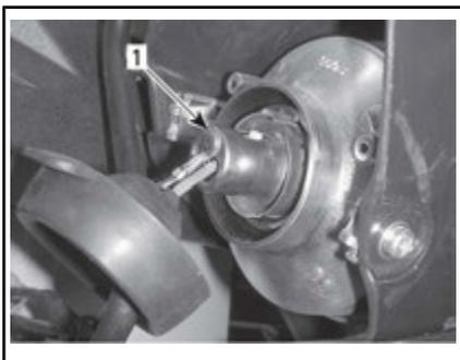
**DRÜCKEN SIE AUF DIE GLÜHLAMPENFASSUNG UND DREHEN SIE SIE IM UHRZEIGERSINN**
