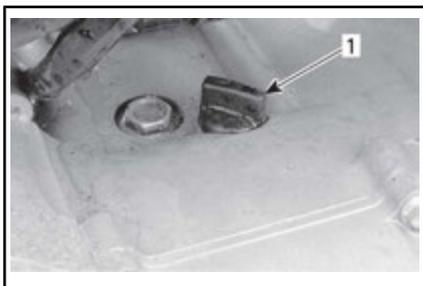
**EINFÜLLSCHRAUBE — LINKE MOTORSEITE**
