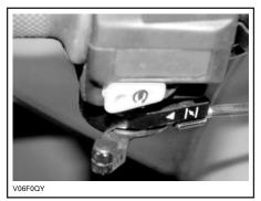
CHOKE LEVER IN THE FULL CHOKE POSITION
