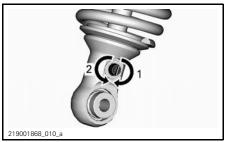
REBOUND DAMPING - BOTTOM OF SHOCK ABSORBER
