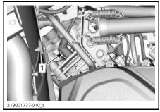
LH SIDE — FRONT CYLINDER 1. Spark plug
