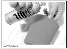
TYPICAL - OIL THE FOAM FILTER ELEMENT
