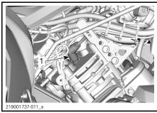
RH SIDE — REAR CYLINDER 1. Spark plug
