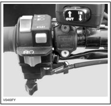
CHOKE LEVER IN THE FULL CHOKE POSITION
