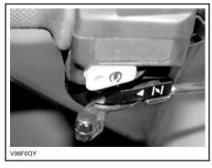
CHOKE LEVER IN THE FULL CHOKE POSITION
