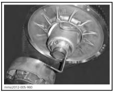
PULLEY EXPANDER INSTALLED ON ADJUSTER HUB
