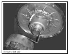
PULLEY EXPANDER INSTALLED ON ADJUSTER HUB
