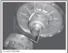
PULLEY EXPANDER ON ALUMINUM ADJUSTER HUB
