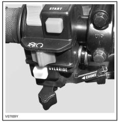
CHOKE LEVER IN THE FULL CHOKE POSITION
