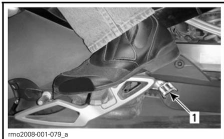
1. Pedale del freno di stazionamento
