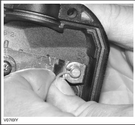
Entfernen Sie die Seitenabdeckung der Drosselklappe.
