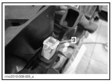
FUSE LOCATED UNDER THE LH REAR SIDE PANFI
