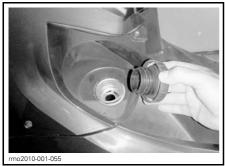
FUEL CAP ON LEFT SIDE UNDERNEATH SEAT
