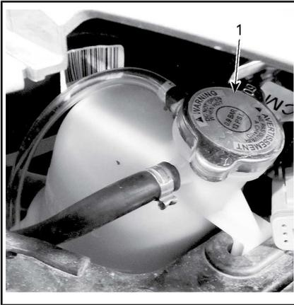
1. Bouchon du réservoir de liquide de refroidissement
