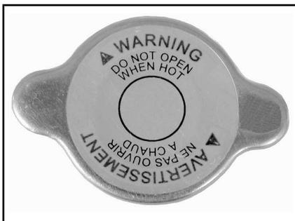
BOUCHON DU RÉSERVOIR DE LIQUIDE DE REFROIDISSEMENT
