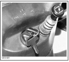
CHOKE LEVER IN THE FULL CHOKE POSITION
