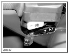
TYPICAL — CHOKE LEVER IN THE FULL CHOKE POSITION
