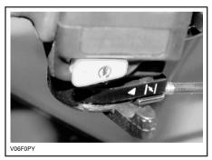
TYPICAL — CHOKE LEVER IN THE OFF POSITION
