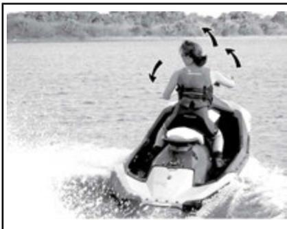
Durch Drehen des Lenkers wird die Strahlpumpendüse geschwenkt, wodurch wiederum die Fahrtrichtung bestimmt wird. Durch Drehen des Lenkers nach rechts steuern Sie das Wasserfahrzeug nach rechts. Durch Drehen des Lenkers nach links steuern Sie das Wasserfahrzeug nach links. Der Gashebel muss betätigt werden, um das Fahrzeug zu drehen.
