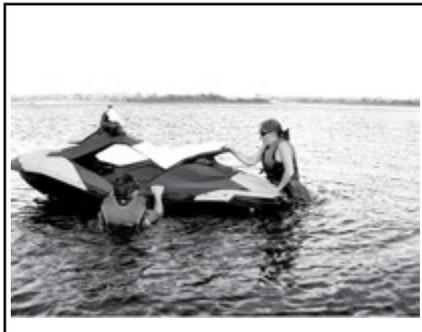
Dann klettert der Mitfahrer auf das Fahrzeug, während der Fahrer das Gleichgewicht hält, indem er sich möglichst nah an die Konsole setzt.
