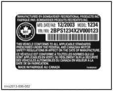
TYPICAL — LABEL 1 - VEHICLE SERIAL NUMBER LABEL UNDER GLOVE BOX
