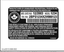
TYPICAL — VEHICLE SERIAL NUMBER LABEL UNDER GLOVE BOX
