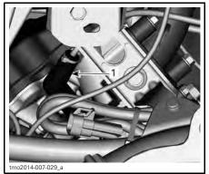
LH SIDE — FRONT CYLINDER 1. Spark plug
