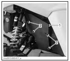
ACCESS TO DRAIN PLUG FROM LH SIDE OF VEHICLE
