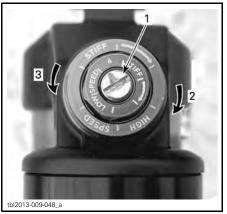
LOW SPEED COMPRESSION DAMPING (USE A SCREWDRIVER)
