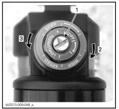
LOW SPEED COMPRESSION DAMPING (USE A SCREWDRIVER)
