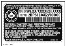
TYPICAL — VEHICLE SERIAL NUMBER LABEL BEHIND THE PASSENGER SEAT
