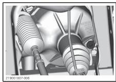
TYPICAL VISCO-LOC- FRONT RIGHT SIDE OF VEHICLE
