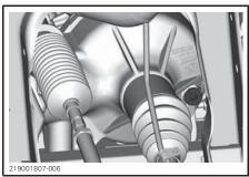
TYPICAL VISCO-LOC- FRONT RIGHT SIDE OF VEHICLE
