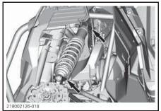
FRONT SHOCK ABSORBER FASTENERS
