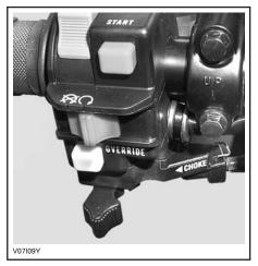
CHOKE LEVER IN THE FULL CHOKE POSITION
