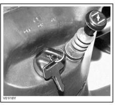
CHOKE LEVER IN THE FULL CHOKE POSITION
