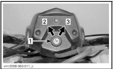
**TYPICAL — IGNITION SWITCH POSITIONS** 1. Ignition switch
