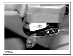
CHOKE LEVER IN THE FULL CHOKE POSITION
