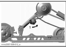
TYPICAL — SC-5 — RH SIDE 1. Adjust spring preload
