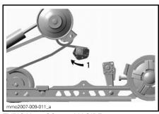
TYPICAL — SC-5 — LH SIDE 1. Adjust spring preload
