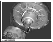
PULLEY EXPANDER INSTALLED ON ADJUSTER HUB
