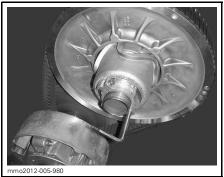
PULLEY EXPANDER INSTALLED ON ADJUSTER HUB
