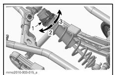
. CAM TYPE - HPG™ SHOCK ABSORBER
