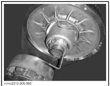
PULLEY EXPANDER INSTALLED ON ADJUSTER HUB
