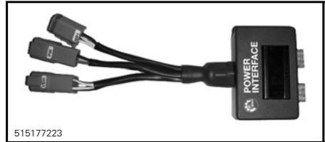
4. Schließen Sie die Stromversorgungsschnittstelle an eine 12 V-Batterie an, unter Verwendung des 12 V-BATTERIE-ANSCHLUSSKABELS (T/N 529 035 997).
