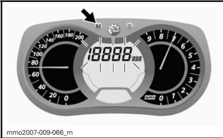
Drücken Sie die Taste SET (S), während die Anzeige blinkt, um den Modus Fahrzeugdurchschnittsgeschwindigkeit (AVR\_SPD) auszuwählen.
