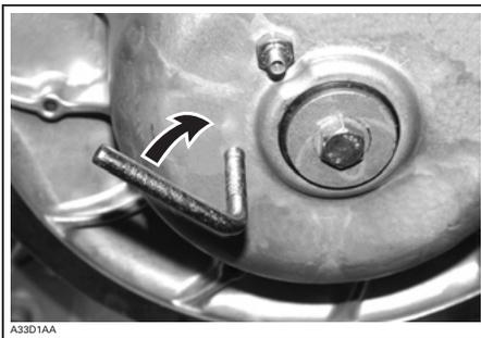
4. Öffnen Sie die Abtriebsscheibe, indem Sie das Werkzeug hineindreihen.
