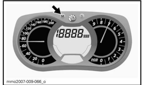
Drücken Sie zum Zurückstellen der aufgezeichneten Maximaltemperatur die Taste MODUS (M) und wählen Sie so einen Modus aus.
