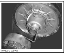
PULLEY EXPANDER INSTALLED ON ADJUSTER HUB
