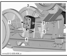
COUPLING BLOCK - RIGHT SIDE VIEW (R - RIGHT EMBOSSED ON BLOCK)
