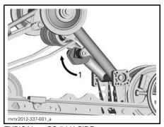
TYPICAL — SC-5 LH SIDE 1. Adjust spring preload
