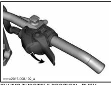
THUMB THROTTLE POSITION : PUSH DOWNWARD TO ROTATE THROTTLE HOUSING
