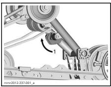
TYPICAL — LH SIDE 1. Adjust spring preload
