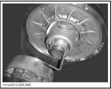
PULLEY EXPANDER INSTALLED ON ADJUSTER HUB
