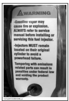
LABEL 18 - ON FUEL INJECTORS - E-TEC **MODELS**
