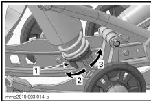
CAM TYPE - MOTION CONTROL SHOCK ABSORBER
