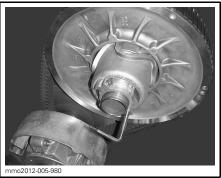
PULLEY EXPANDER INSTALLED ON ADJUSTER HUB
