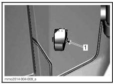
TYPICAL - LH SIDE OF FUEL TANK 1. Mode switch
