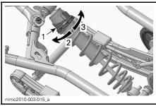
CAM TYPE - HPG™ SHOCK ABSORBER
