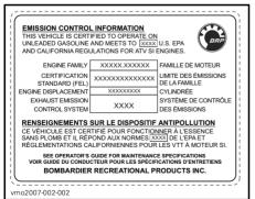
LABEL 8: LOCATED UNDER SEAT ON THE UPPER BAR OF FRAME
