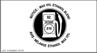
LOCATED ON FUEL CAP - ON 600 EFI ENGINE (IN COUNTRIES USING RON OCTANE RATINGS)
