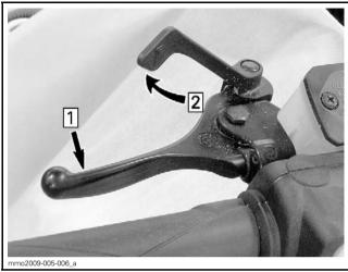
TYPICAL — ENGAGE MECHANISM
