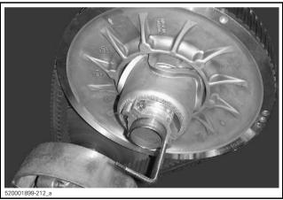
TYPICAL - PULLEY EXPANDER INSTALLED ON ADJUSTER HUB
