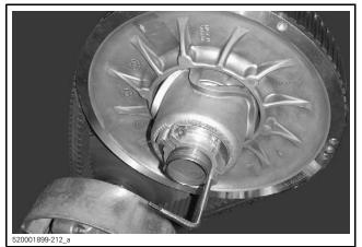
TYPICAL - PULLEY EXPANDER INSTALLED ON ADJUSTER HUB
