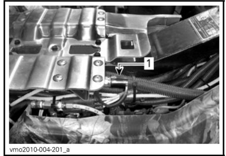
1. Acoplamiento del compresor
