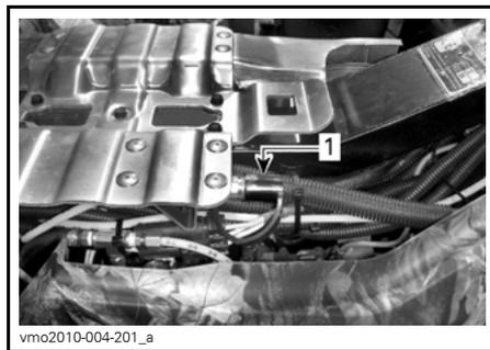
1. Acoplamiento del compresor
