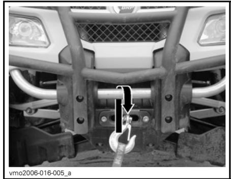
**TÍPICO - TODOS LOS MODELOS EXCEPTO EL 800R X XC - PUNTO DE ANCLAJE DELANTERO**
