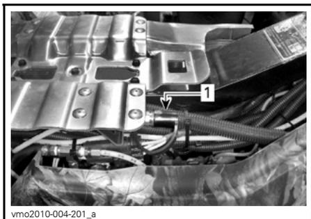
1. Conexão do compressor
