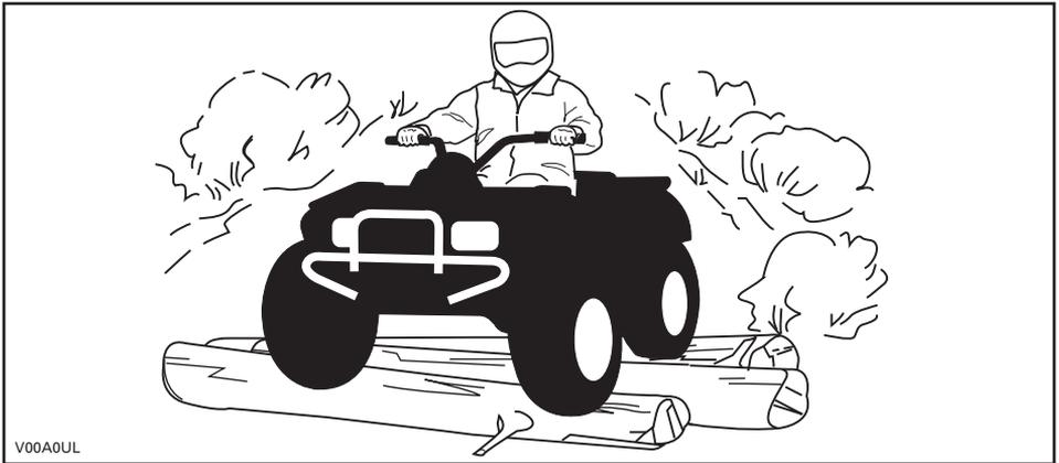
Aunque el vehículo está equipado con un sistema de suspensión adecuado, existen terrenos "muy accidentados", llenos de baches, por los que la conducción puede resultar incómoda e incluso dañar la espalda. A menudo será necesario conducir casi "en cuclillas". Reduzca la velocidad y flexione las piernas para absorber parte de la fuerza del impacto.
