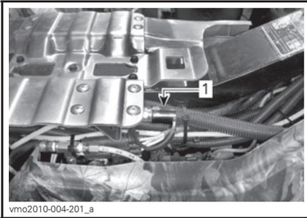
1. Acoplamiento del compresor
