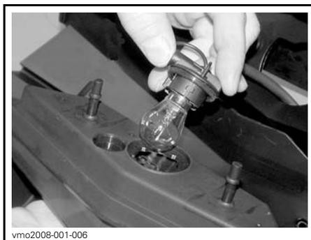
Enfoncer l'ampoule dans sa douille et, tout en maintenant une pression, la tourner dans le sens antihoraire pour la dégager.
