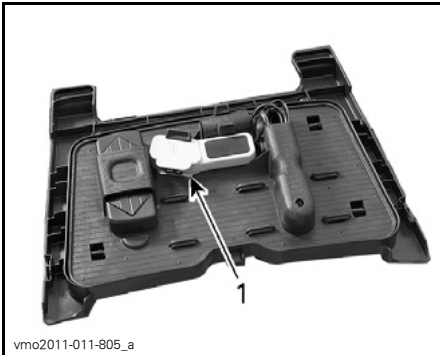
TYPISCH — DEKSEL BERGVAK ACHTERAAN 1. Afstandsbediening lier
