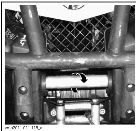
TYPISCH PLAATS VAN HET BEVESTIGINGSPUNT VOORAAN
