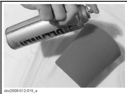
TYPISCH - SPIUIT HET OP HET SCHUIMELEMENT
