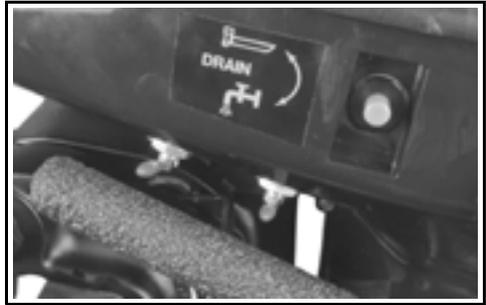
Relever le moteur hors-bord jusqu'à sa position maximale et le basculer de sorte que les vannes de vidange soient en bas.
