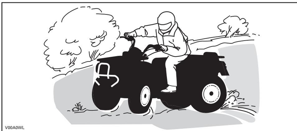
Si el vehículo derrapa o resbala, puede resultar de utilidad girar el manillar en la dirección del deslizamiento hasta que vuelva a recuperar el control. Procure que no se bloqueen nunca los frenos ni las ruedas.
