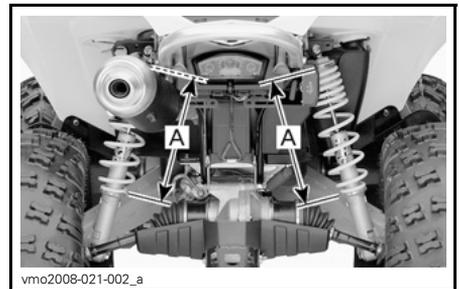
**TÍPICO — AJUSTE DE PRECARGA EN LA PARTE TRASERA**
